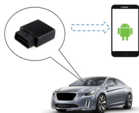
Figura 2.17: Esquema de coleta de dados usando a interface OBD e o smartphone
